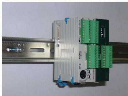
c) Откройте защелку для монтажа GLT – базового модуля на ДИН-рейку.
