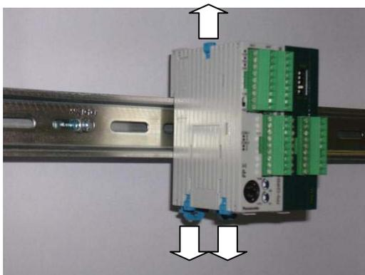
b) Снимите крышку закрывающую разъем с левой стороны установленного PLC контроллера.
