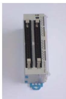
d) Сначала установите GLT - базовый модуль на ДИН-рейку, затем подвиньте его к PLC контроллеру так, чтобы их разъемы соединились.
