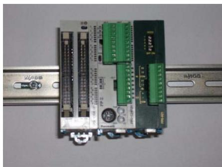
e) В заключение закройте все замки для крепления модулей на ДИН-рейку и между собой.
