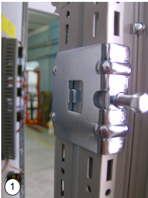
Монтаж стягивающего соединителя на вертикальных профилях шкафа
