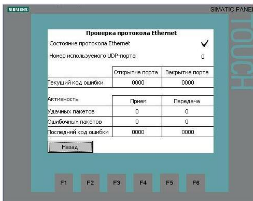
Рис. 11. Мастер наладки. Проверка правильности подключения. Проверка протокола Ethernet.
