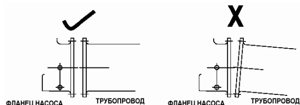
Рис. 13. Выравнивание корпуса насоса с трубопроводом
