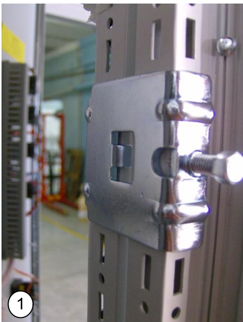
Монтаж стягивающего соединителя на вертикальных профилях шкафа
